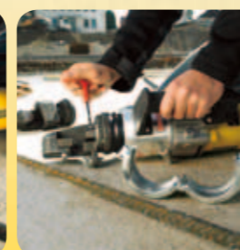
2 Rezni blok na reznom klipu uklonite popuštanjem vijaka.
