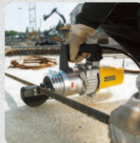
Škare rezne glave RCP 20 s rasteretnim ventilom
