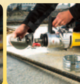
3 Reznu glavu zamijenite glavom za savijanje.
